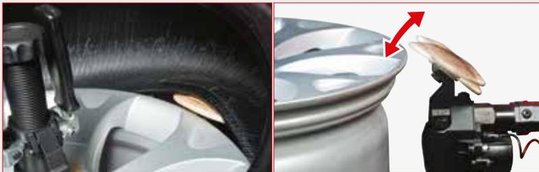
El procedimiento de desmontaje rápido del segundo talón es posible por el movimiento del disco patentado.
