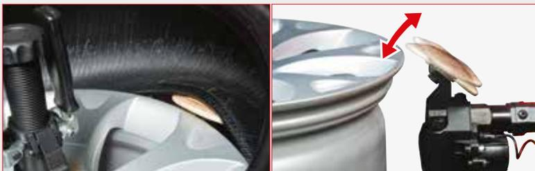
**Procédure rapide** de démontage du deuxième talon, possible grâce au **mouvement du disque breveté**.
