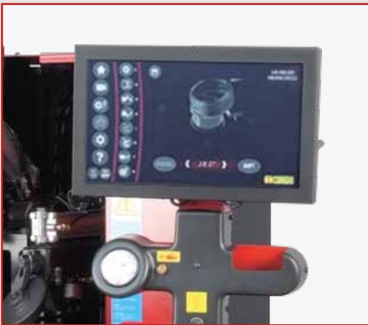
Die Master Force bietet die Möglichkeit, die Reifenmontiermaschine über **den automatischen Arbeitszyklus zu nutzen**. Die dank der Erfahrung von Corghi verbesserte Verwaltungssoftware zielt auf **den Schutz von Felgen und Reifen ab**. Automatische Arbeitsabläufe wie
