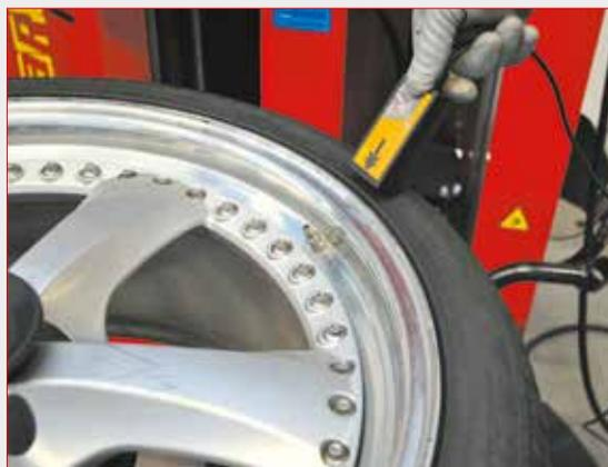
strumento per intercettare sensore e dati relativi
