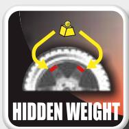
**Perfecta estética de la llanta** porque permite dividir el peso adhesivo de equilibrio del flanco externo en dos pesos equivalentes colocados en una posición oculta detrás de los radios. **Perfeita estética do aro** porque permite dividir o peso adesivo de balanceamento do lado externo em dois pesos equivalentes colocados em posição oculta atrás dos raios.
